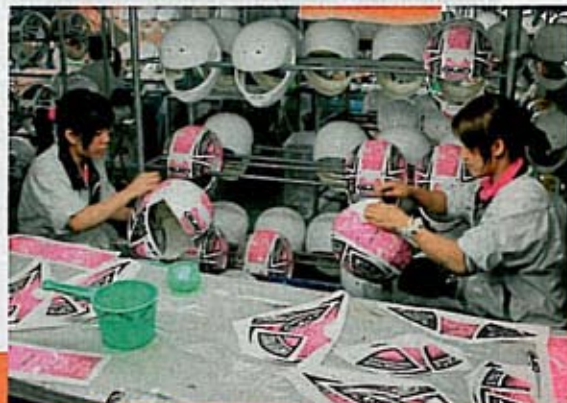
Muss auf den Millimeter genau stimmen: das Bekleben der Außenschalen mit den Dekorbögen der HJC-Designer
