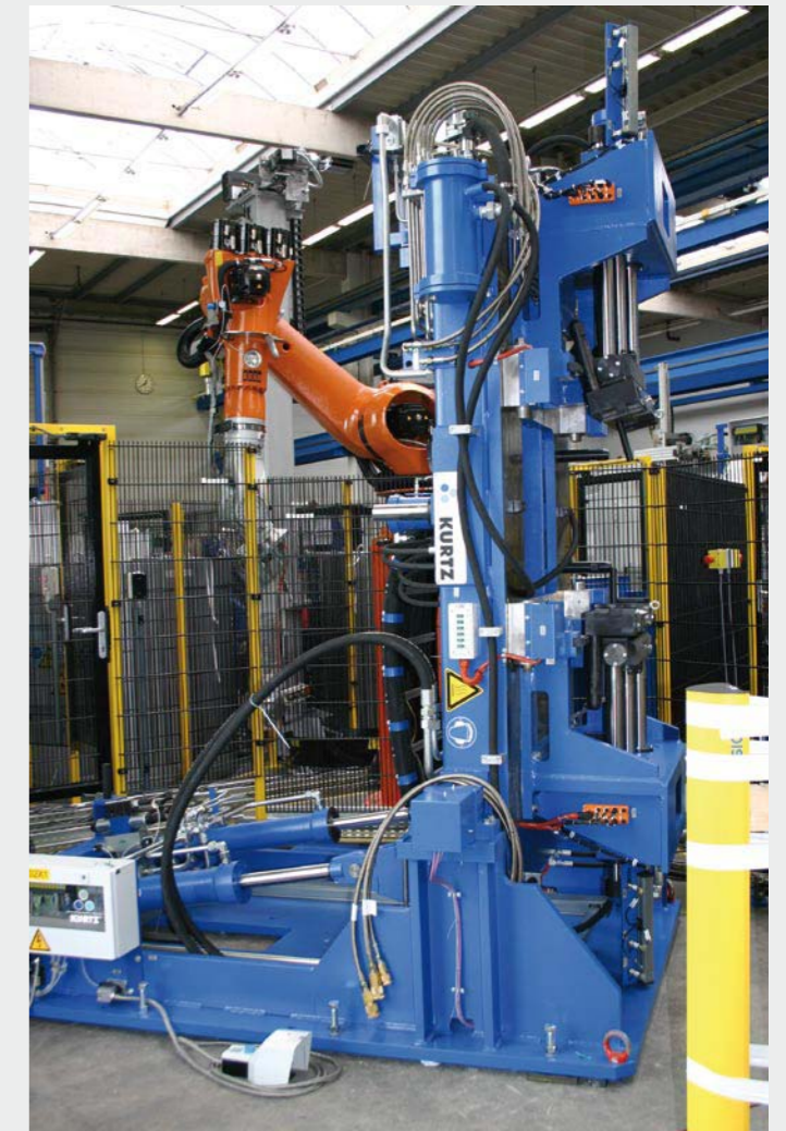
Kippgießmaschine, 90° gekippt, servohydraulische Kippbewegung, Kippwinkel bis 110°
