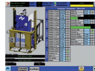
Visualisierung über großes Farbdisplay mit geführter Anlagenbedienung. Auswahl und Aktivierung direkt über die geschützte Tastatur. Programme direkt auf SD-Karten speicherbar
