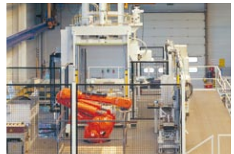
Zellenautomatisierung mit Roboter, Schutzzaun, Graten-entsorgung und CE-Zertifizierung der Gesamtanlage
