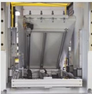
Beidseitig geführte Entnahme im gekippten Zustand. Integrierte Blasleiste an der Vorderseite. Entnahmeblech kann zur Vereinzelung aufgeteilt werden.
