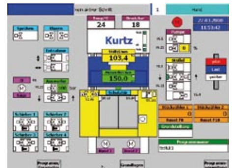
Visualisierung über großes Farbdisplay mit geführter Anlagenbedienung Auswahl und Aktivierung direkt über die geschützte Tastatur Ablaufprogramme unmittelbar auf SD-Karten speicherbar
