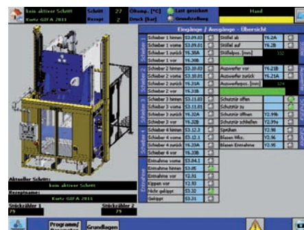
Visualisierung über großes Farbdisplay mit geführter Anlagenbedienung. Auswahl und Aktivierung direkt über die geschützte Tastatur. Ablaufprogrammme unmittelbar auf SD-Karten speicherbar.
