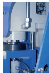
Absensicherung, Stößelanbindung, Auswerfer mit Wegmessung
